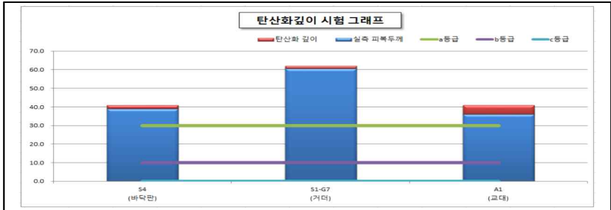
【그림 1.4.5】 탄산화깊이 시험 그래프
